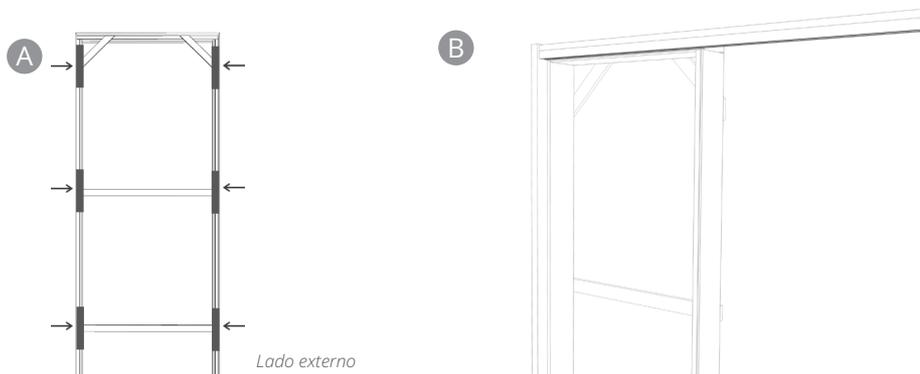
**ATENÇÃO:** no caso da instalação de kits montados, antes de aplicar a espuma, deve-se fazer a marcação da colocação dos parafusos (B). Com o kit nivelado, fazer um pré-furo no suporte do trilho, fazendo a marcação na parede. Utilizar quatro parafusos que acompanham o kit (5,0x70). Após a secagem da espuma, pode-se inserir os parafusos para fixação na parede.
