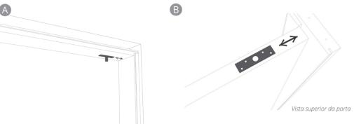
Para fazer a usinagem, calcule 105mm entre o batente lateral e o centro do furo (para portas de 1.000mm) ou 125mm (para portas de 1.200mm). Instale também a ferragem na porta (B).
