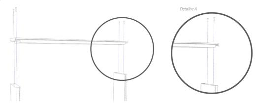
Fixe as travas nos batentes (A) e ajuste com um esquadro o correto alinhamento (B). Depois posicione o conjunto no vão e verifique com um nível o correto alinhamento da estrutura (C):
