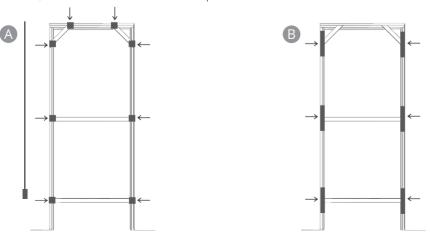
Com o auxílio de uma furadeira, faça as marcações dos pontos em que serão fixadas as ferragens no centro do batente superior (A):
