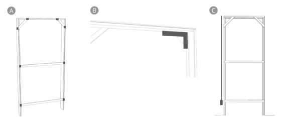
Insira as cunhas como apresentado na figura (A), ajustando a posição correta do conjunto com um nível. Com o conjunto devidamente posicionado e nivelado, aplique a espuma de poliuretano nos pontos das travas, como indicado na imagem (B) – os pontos devem conter em média 30cm. A espuma leva cerca de 24 horas para selar, respeite esse tempo para garantir a qualidade final da instalação. Após a secagem da espuma, tire as cunhas, as travas e retire o excesso de espuma:
