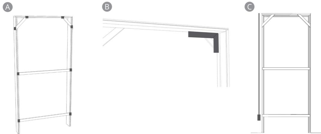
**03** Insira as cunhas como apresentado na figura (A), ajustando a posição correta do conjunto com um nível. Com o conjunto devidamente posicionado e nivelado, aplique a espuma de poliuretano nos pontos das travas, como indicado na imagem (B) – os pontos devem conter em média 30cm. A espuma leva cerca de 24 horas para selar, respeite esse tempo para garantir a qualidade final da instalação. Após a secagem da espuma, tire as cunhas, as travas e retire o excesso de espuma.
