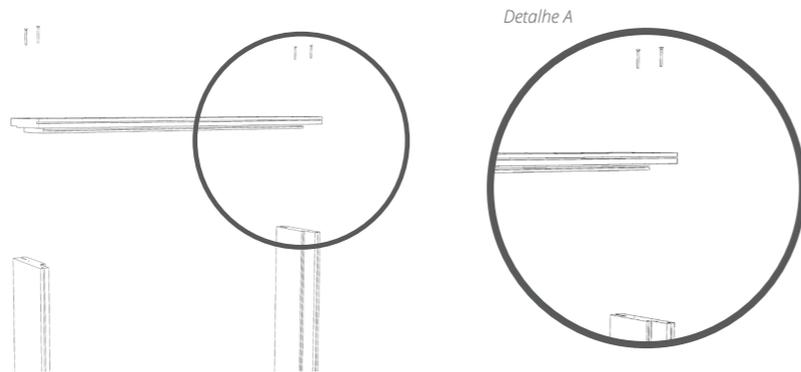
**02** Fixe as travas nos batentes (A) e ajuste com um esquadro o correto alinhamento (B). Depois posicione o conjunto no vão e verifique com um nível o correto alinhamento da estrutura (C):
