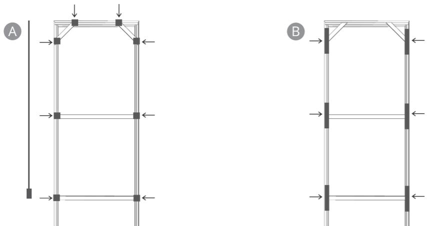
**04** Instale as dobradiças nos locais indicados da porta (A) e, em seguida, fixe o conjunto do batente (B):
