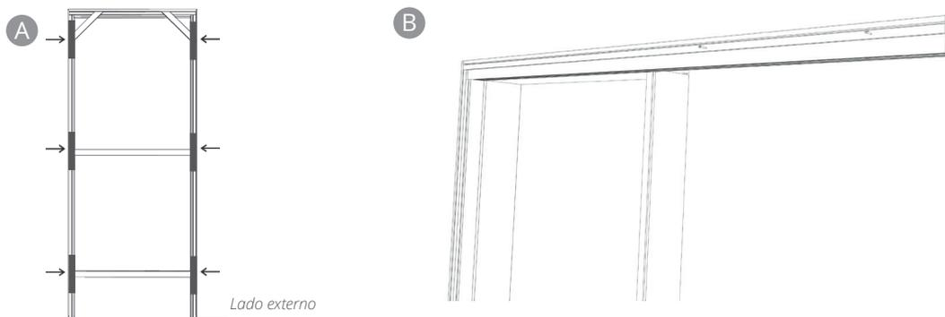
**ATENÇÃO:** no caso da instalação de kits montados, antes de aplicar a espuma, deve-se fazer a marcação da colocação dos parafusos (B). Com o kit nivelado, fazer um pré-furo no suporte do trilho, fazendo a marcação na parede. Utilizar dois parafusos que acompanham o kit (5,0x90). Após a secagem da espuma, pode-se inserir os parafusos para fixação na parede.
