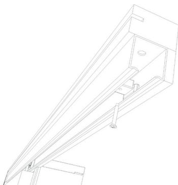
**11** Fixe as guarnições fazendo o acabamento da porta (A). Perceba que elas possuem uma regulagem, para caso a espessura da parede apresente imperfeições ou diferenças nas medidas. Finalize a instalação fixando o acabamento com dois parafusos na parte superior (4x25) (B).
